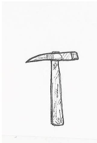
*Martelo de pena:* Federhammer, die Bahn ist wie beim Martelo de bico, die Finne allerdings ähnelt der eines Schlosserhammers. Auch dieser Hammer wird zum Setzen und Bearbeiten der Steine verwendet.
