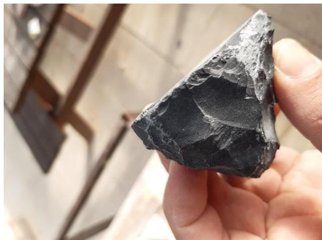
Ein konisch zugeschlagener Stein, für möglichst enge Fugen
